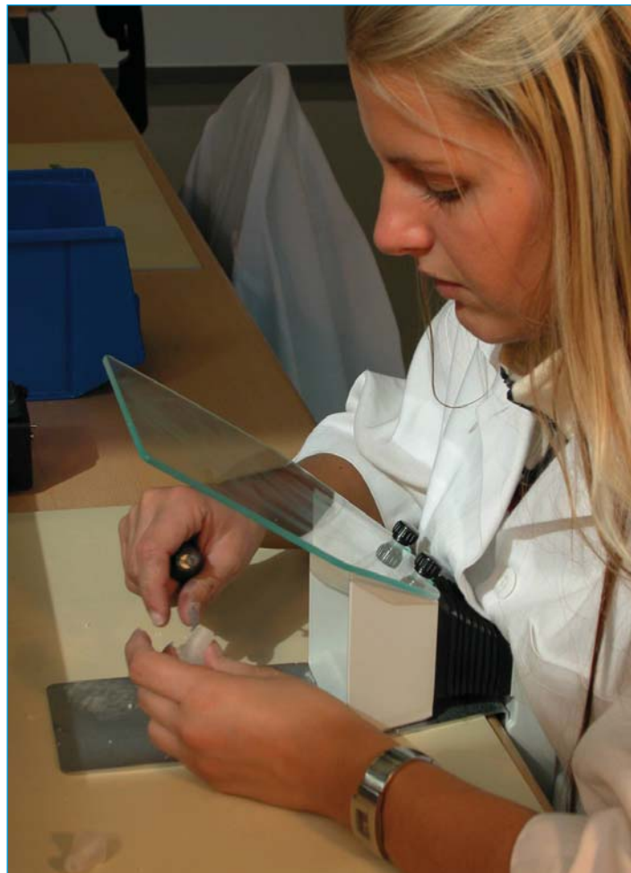
Na het uitharden en ontvormen wordt het oorstukje manueel bijgewerkt in het labo.
